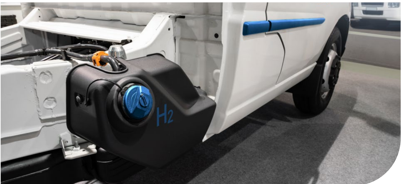
Abbildung 2: Brennstoffzellenelektrische LKW sind elektrisch angetriebene Fahrzeuge mit kleinerer Batterie und zusätzlichem Wasserstofftank sowie zusätzlicher Brennstoffzelle.
