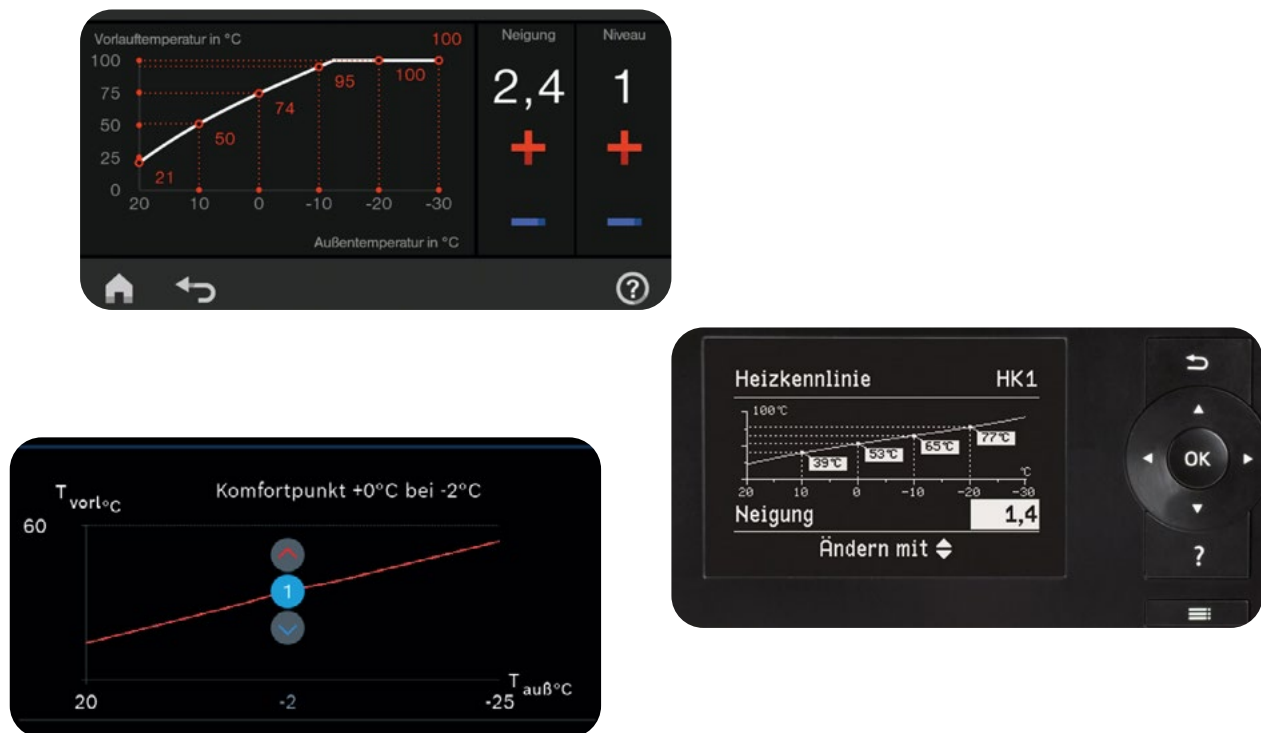
Abb. 5: Exemplarische Anzeigen zur Einstellung der Heizkurve bei verschiedenen Herstellern [5], [6], [7]
