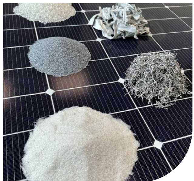
PV-Module werden zu den Grundstoffen Glas (Fein- und Grobkorn), Silizium, Kupfer und Aluminium recycelt
